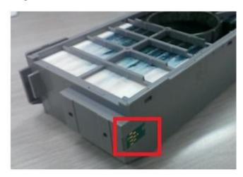
步驟 3、清潔完晶片後,再將廢墨水收集盒安裝回去,確認機器是否有偵測正常 (如下圖),若依上述方式仍無法改善,建議可再更換新的耗材「廢墨水收集盒」 再測試之。
